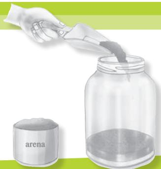
2. Luego, coloque una capa de arena de 2 cm de espesor sobre la piedra pómez.
